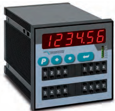
Variante 644 avec 4 présélections / relais L x H x P = 96 x 96 x 140 mm
